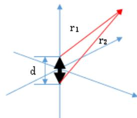
8. 双極子のような小さな電流素で、放射を考える場合、観測点から光源部の各点までの距離が波長以上に違っていると、角度によってその放射の強弱がつかなくなることが考えられる。右図を参考に、電流素の長さ  $d$  が波長の 2 倍ある場合、どのような放射パターンになるか、説明しなさい。
