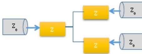
22.  $50\Omega$  のケーブルを  $200\Omega$  のインピーダンス線路に接続しようとした場合、反射率を 20% 以下にするためには、どのようにすればいいか、定量的に答えなさい。
